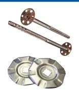
Nicht brennbar, aus Edelstahl! Zur nachträglichen Andübelung von GEROLITH Deckendämmelementen, Kellerdecken-Dämmelementen in Räumen mit höherer Anforderung an die Korrosionsbeständigkeit z. B. Tiefgaragen. Bohrlochdurchmesser 8 m
